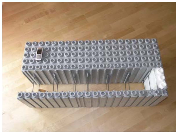
Slika 2: zidaki iz polistirena so široki 100 cm, v vmesno odprtino se namesti armaturo in zalije z betonom (na sliki v primerjavi z velikostjo prenosnega telefona)
